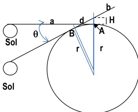
Entre as duas tangentes tem-se um ângulo  $\theta$ . Do ponto A ao centro da Terra, tem-se o raio da Terra mais a altura  $H$ . Desta forma pode-se ter um triângulo retângulo em B que define  $d$ , a distância entre este ponto (ponto da tangência) e os olhos do observador. Assim pelo teorema de Pitágoras vem:
